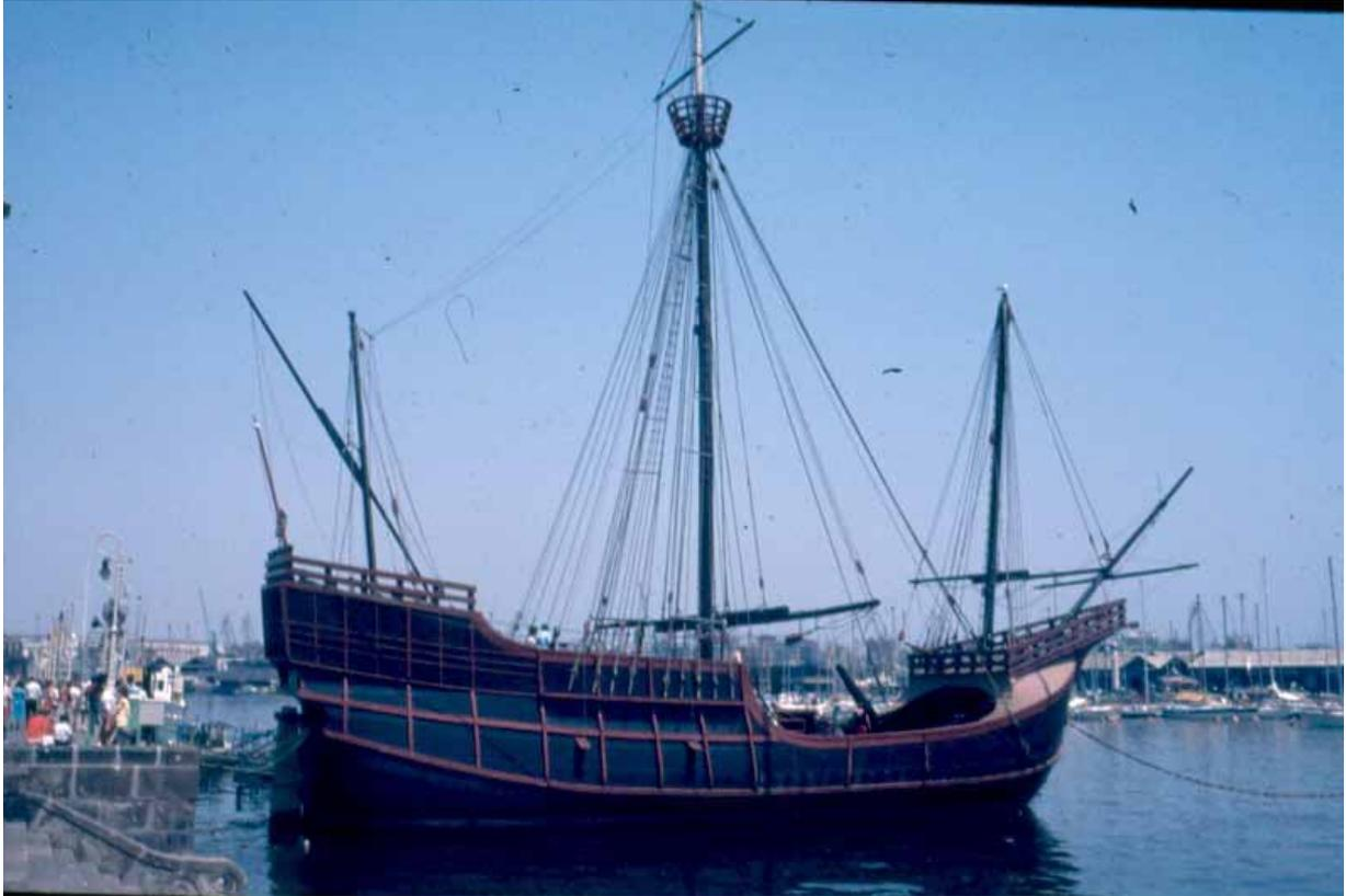
Obwohl die Santa Maria wiederholt nachgebaut wurde, genaue Maße sind nicht überliefert. Vermutlich war das drei-mastige Schiff mit der Binde am Klüver 25 Meter im Rumpf lang, die Masten erreichten 25 Meter und trugen 350 qm Segel. Auf dem Schiff lebten über 40 Mann. Sein Flaggschiff ging schon auf der ersten Entdeckungsreise verloren. Es war langsam und konnte schlecht am seitlichen Wind segeln. **053-ES.B-84g3461**
